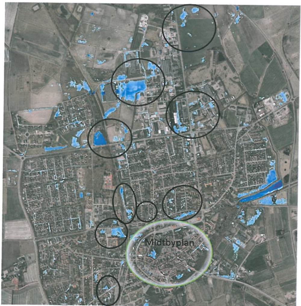
Figur 4 Beregnet oversvømmelsesudbredelse ved en 50 års regnhændelse med fyldte kanaler. Fokusområder i projektet er indhegnet med cirkler. Jo mørkere farve, des dybere vandstand.
